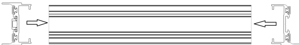
Εικόνα 1.8.1: Εγκατάσταση κάθετων προφίλ στο κάτω οριζόντιο προφίλ
