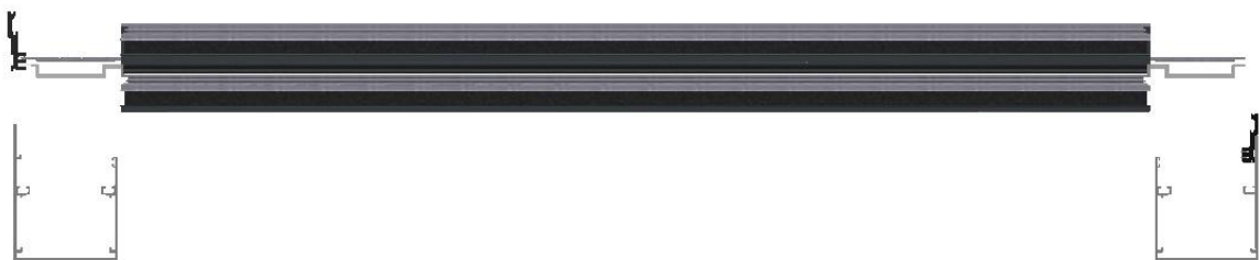
Εικόνα 11: Ξεβιδώνουμε τη μια «γλύστρα» και την «κουμπώνουμε» στα πλαίσια
