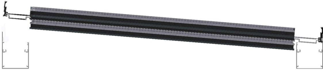
Εικόνα 12: «Κουμπώνουμε» την άλλη άκρη των πλαισίων στη «γλύστρα» που δεν έχουμε ξεβιδώσει
