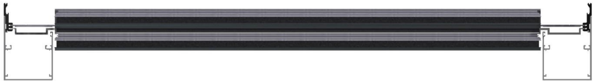
Εικόνα 13: Φέρνουμε τα πλαίσια σε ευθεία και βιδώνουμε ξανά τη «γλύστρα»
